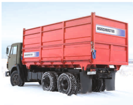
Имеет увеличенный объем кузова и увеличенную высоту основного и надставных бортов.
