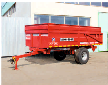
«ISON - 8507». Грузоподъемность 7 тонн, объем кузова 13 м³.
