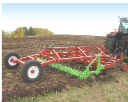
Чизельный плуг требует меньших энергозатрат, менее мощного трактора.
