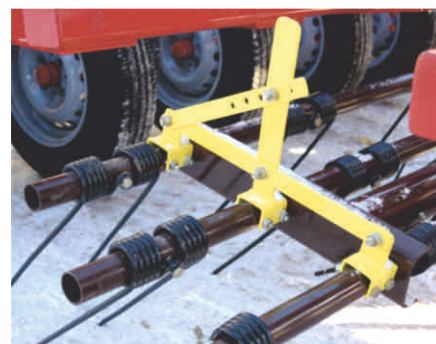
Трехрядная пружинная борона для выравнивания почвы и создания одинакового слоя почвы над семенами.
