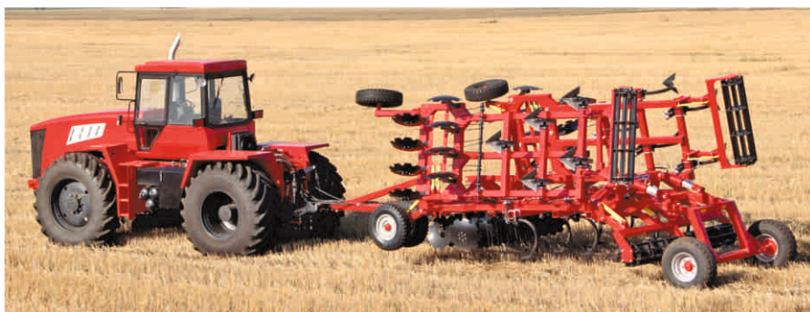
Эффективные клиновидные культиваторные лапы, тяжелые диски на индивидуальных стойках – прекрасное орудие для предпосевной обработки.
