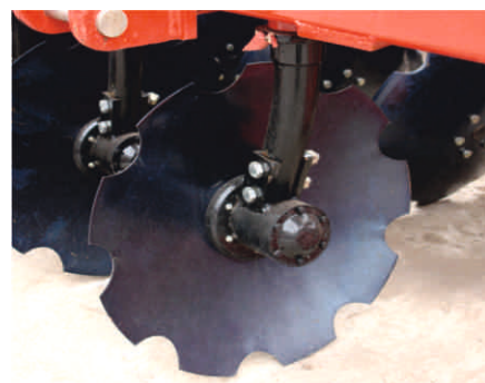
Каждый обрабатывающий диск установлен на индивидуальной стойке в 4 ряда и имеет наклон от вертикальной оси.
