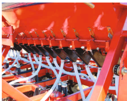
Система контроля высева «АРЫШ» предназначена для контроля и индикации технологических параметров.
