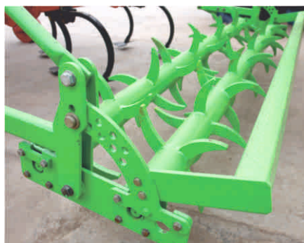
Двухрядный зубовой каток чизельного плуга отлично разделяет и заделывает растительные остатки, а также выравнивает агрофон.
