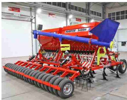
Бункер увеличенной емкости имеет два отсека: для семян и удобрений. Увеличенная емкость бункера повышает производительность агрегата.
