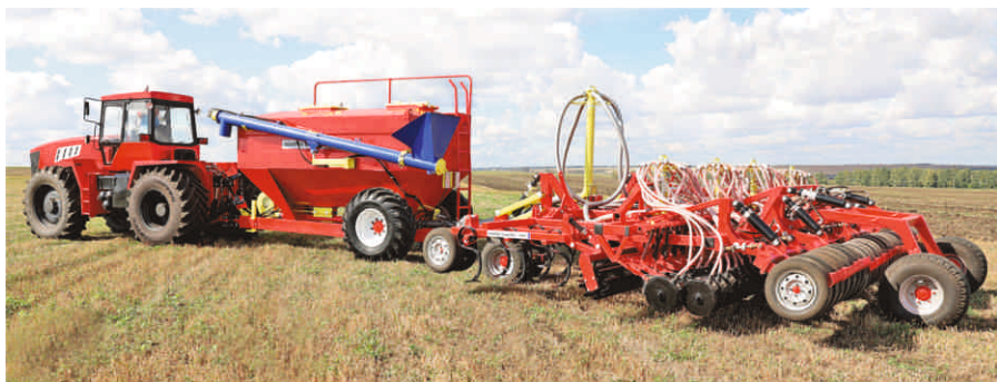
Комбинированный посевной комплекс. Полностью ликвидирует разрыв между предпосевной культивацией и севом. Обеспечивает уникальное прикатывание.
