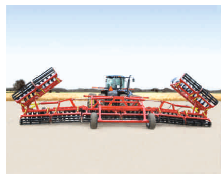
«MEGADISK» превосходит лущильники по интенсивности и глубине обработки почвы благодаря большой ширине захвата.
