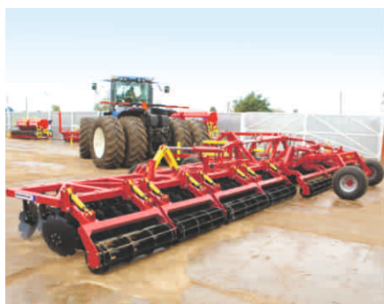
Широкозахватный агрегат для обработки почвы и стерни двумя рядами тяжелых дисков на индивидуальных поворотных стойках.
