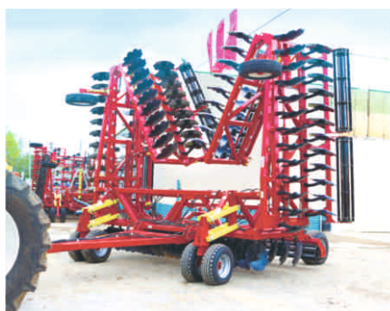
Рама «MEGADISK» состоит из центральной части и двух или четырех боковых рам. Удобное транспортное положение.
