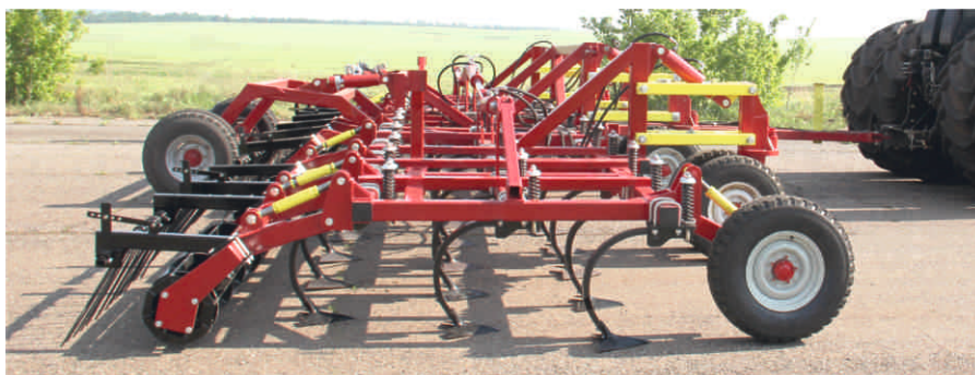
Клин с высоким подъемом подрезает почву в горизонтальной плоскости и интенсивно обрабатывает ее в вертикальной плоскости. Планчатый каток для создания мульчированного слоя почвы и уплотнения.
