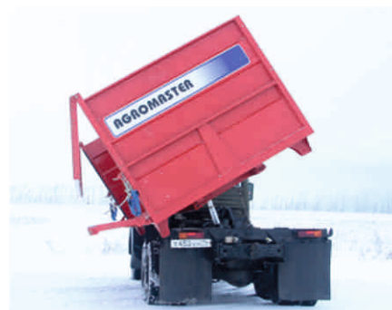
Удобная в эксплуатации конструкция кузова с гидроцилиндром подъема и углом опрокидывания платформы до 50°.
