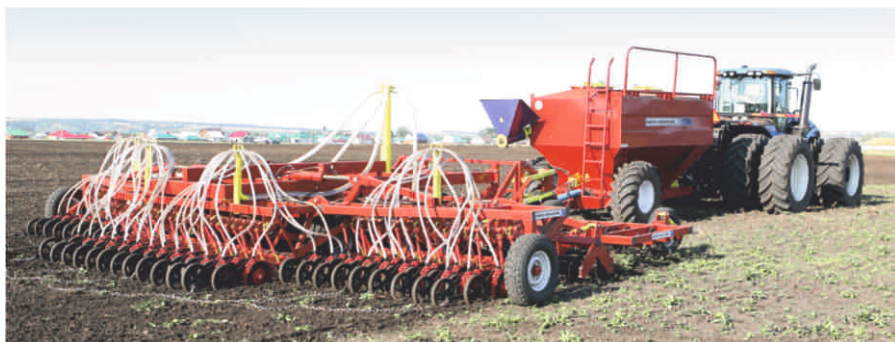
AGRATOR COMBIDISK-9000. Комбинированная сеялка для посева по обработанной почве. Полностью ликвидирует разрыв перед посевной культивацией и севом. Не допускает иссушения почвы.
